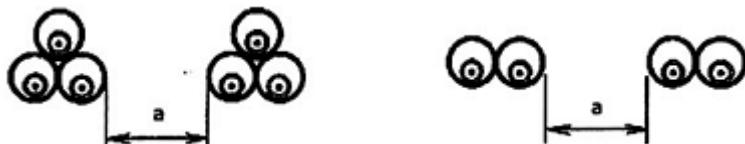
**CHÚ THÍCH 1:** Các giá trị đưa ra áp dụng cho hệ thống lắp đặt ở độ sâu 0,7 m và nhiệt trớ đất bằng  $2,5 \text{ }^{\circ}\text{C.m/W}$ . Chúng là các giá trị trung bình của dải các cỡ cáp và loại được trích dẫn cho Bảng B.52.2 đến B.52.5. Qui trình lấy trung bình cùng với làm tròn, trong một số trường hợp có thể gây ra sai số đến  $\pm 10\%$ . (Trong trường hợp yêu cầu các giá trị chính xác hơn, có thể tính theo phương pháp nêu ở IEC 60287-2-1.)
